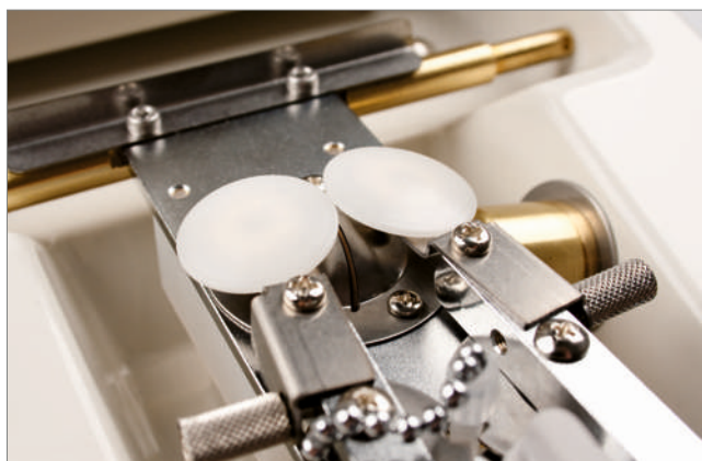
Obustronne prowadzenie szkła przez rolki, posiadające pojedyncze precyzyjne ułożyskowania z tworzywa sztucznego dla dokładnego pozycjonowania rowka
